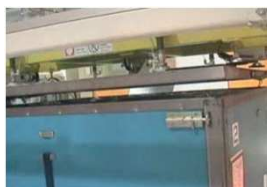
※コンテナフタの自動取り外し装置 及びマガジンへの集積装置
